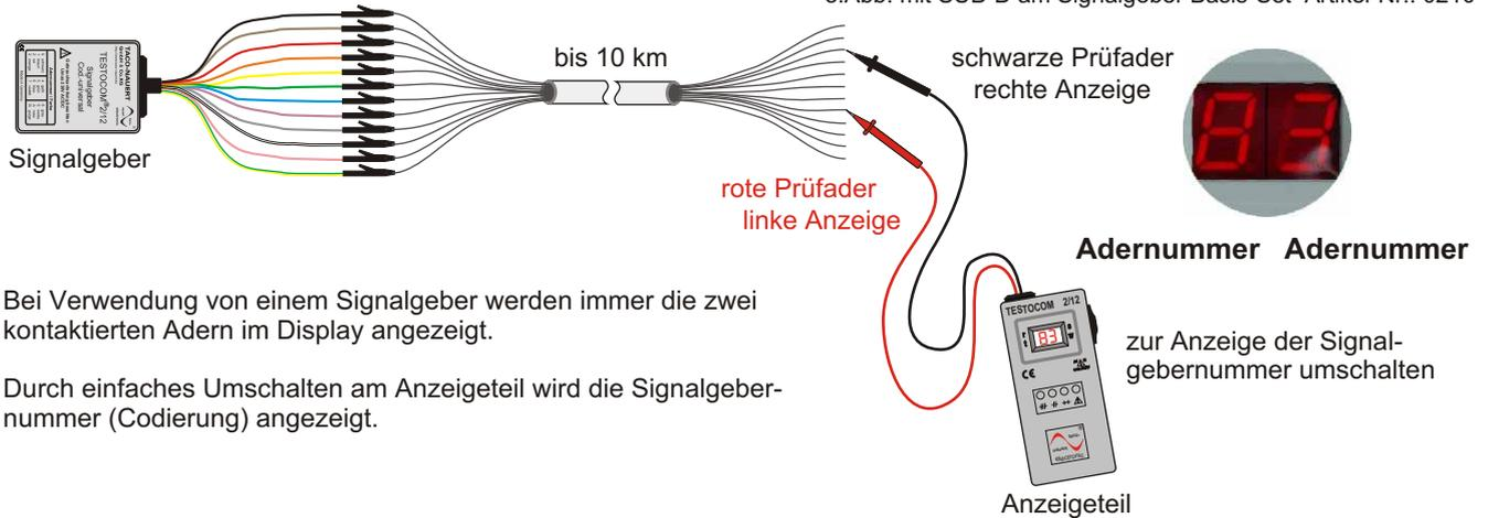
Bei Verwendung von einem Signalgeber werden immer die zwei kontaktierten Adern im Display angezeigt.
